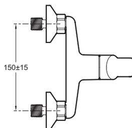
Спецификация продукта : Смеситель для душа. E20847. Коллекция : LUCIEN. МАТЕРИАЛ : N/A. ТИП УСТАНОВКИ : Крепление к стене. ТИП : Однорычажный. РАСХОД ВОДЫ : 12 л/мин. ПОДКЛЮЧЕНИЕ : С соединителями и настенными крепежами. МЕХАНИЗМ : Керамический дисковый картридж.
